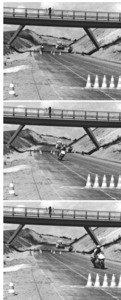
BILD 3: Versuch mit 2 m Seitenversatz aus Sicht der Kamera A
